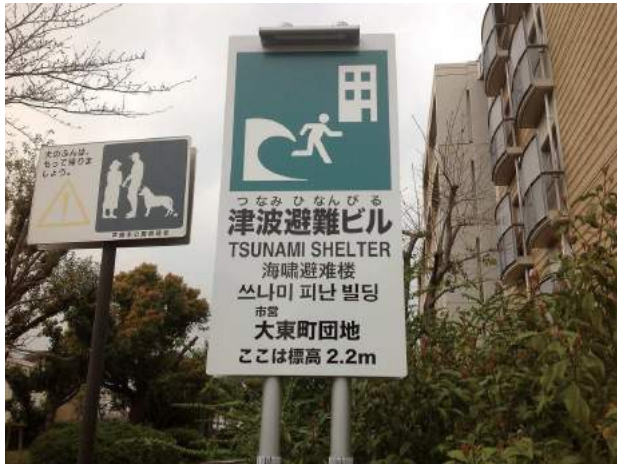
本体：アルミ押出支柱+LEDソーラー照明 印刷：スーパーカラーR+カッティングシート
