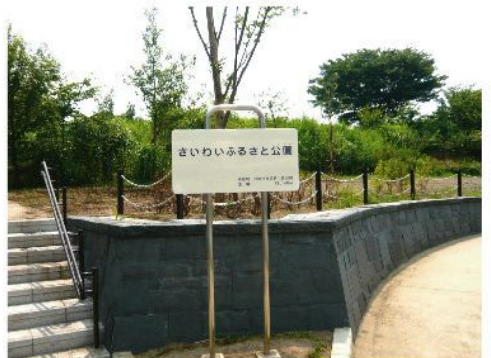
T-029 表示サイズ：w1000×h500 FRP封入板 本体：ステンレス
