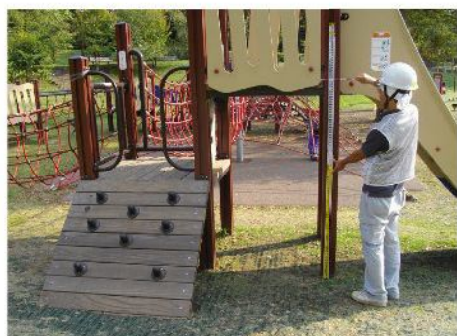
標準劣化点検 落下高の計測
