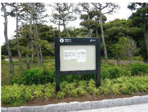
T-037 表示サイズ：w1250×h900 カuttingシート 本体：ステンレス
